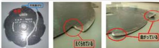
の衝撃負荷の1/10への集中・刃部過熱の解消・熟練者による硬さにより割れやすくなる事の理解・不足割れの原因・使用用途の関連性・刃刃・チップソーの選定の問題点・防護装置の不具合等がある。
